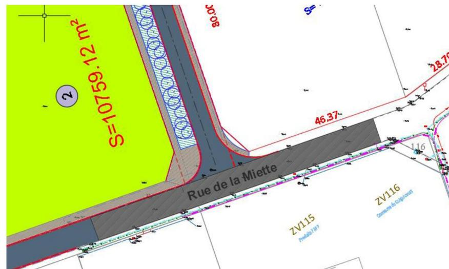
Figure 2 : Plan d'aménagement avec carrefour en T de l'accès 1
